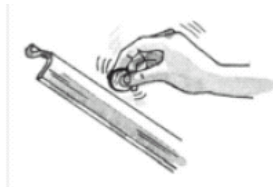
Figure 13 : Test de détection de microfissures
