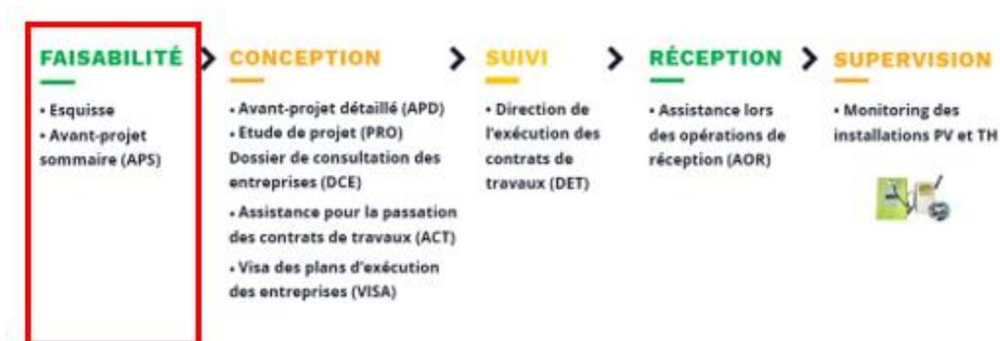
Figure 4: Phases de maîtrise d'œuvre complète [Source: TECSOL]
