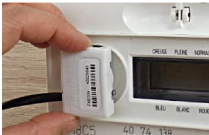
Figure 7: Exemple d'installation d'un lecteur optique sur un compteur.
