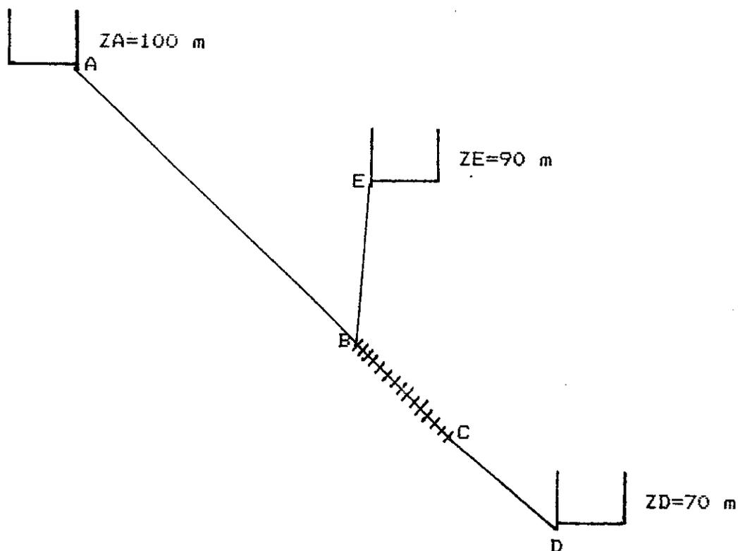
Dans le réseau représenté ci-haut, A, E, D sont des réservoirs. On considère 4 tronçons avec les données suivantes:
