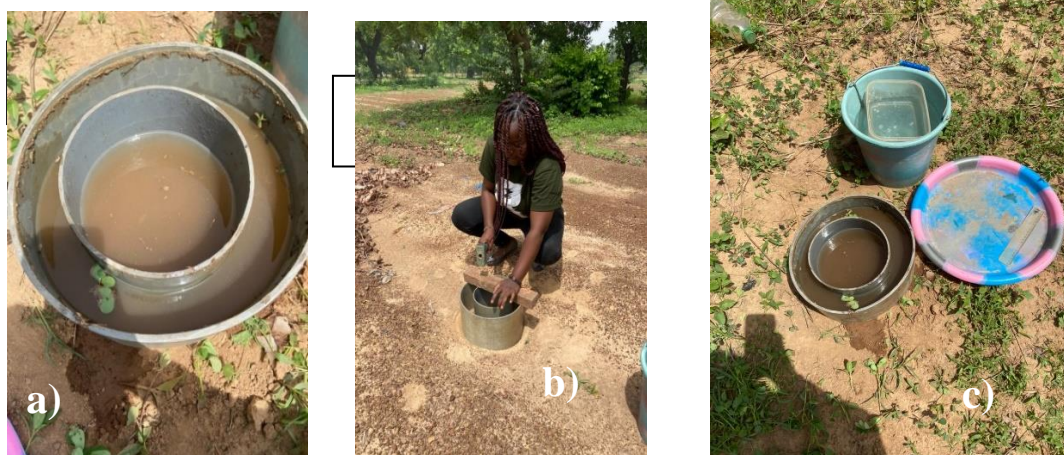
Figure 4 : Réalisation des essais de mesures d'infiltration :( a et b) Implantation des doubles anneaux sur le site ; (c) matériels utilisés lors des essais.
