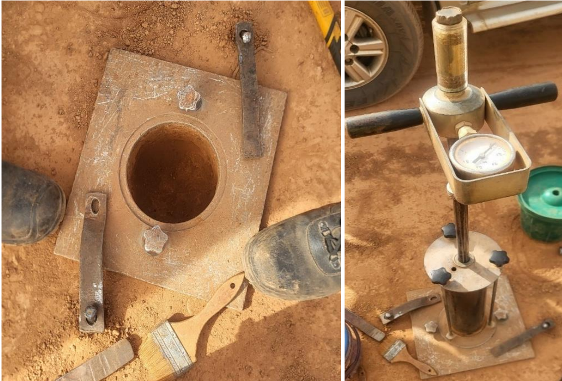
Figure 26: Densitomètre à membrane pour essai de compacité
