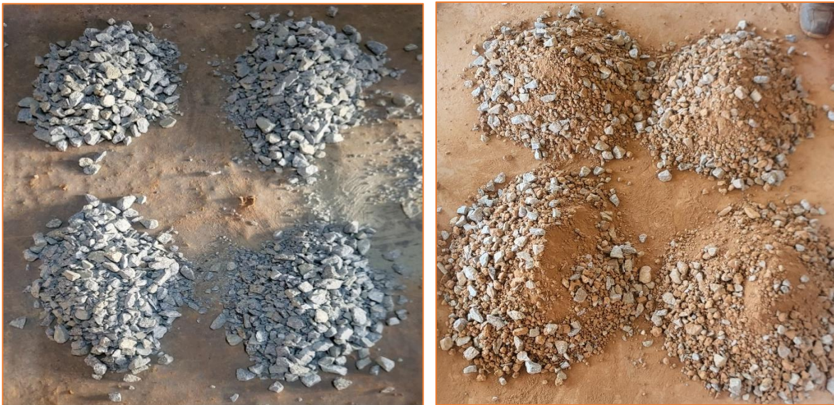
Figure 6: Echantillonnage par la méthode de quartage
