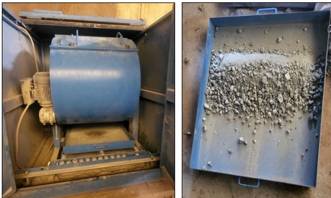
Figure 11: Echantillon et appareil utilisé pour l'essai de Los Angeles
