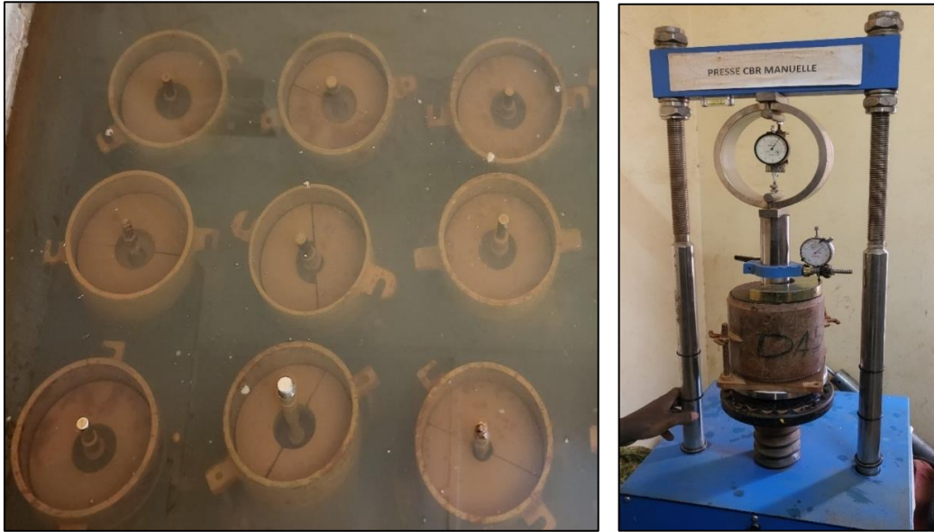
Figure 14: Moules CBR immergés dans l'eau et Presse CBR pour poinçonnement
