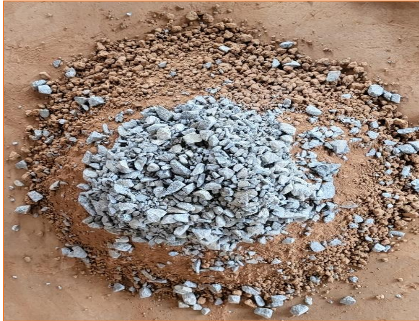
Figure 21: Mélange du graveleux latéritique et concassé 5/25
