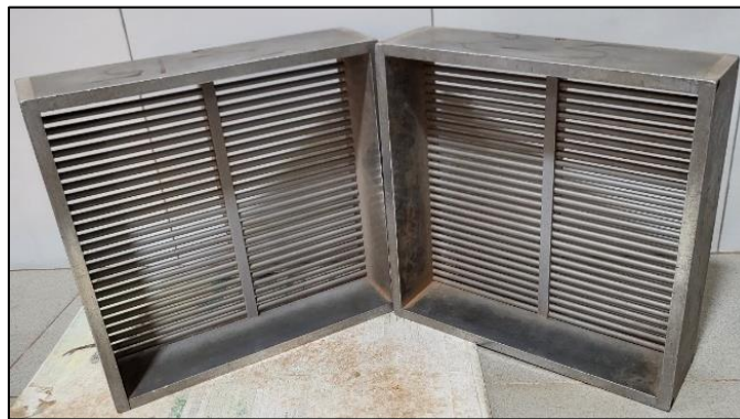
Figure 10: Tamis à fente pour l'essai d'aplatissement
