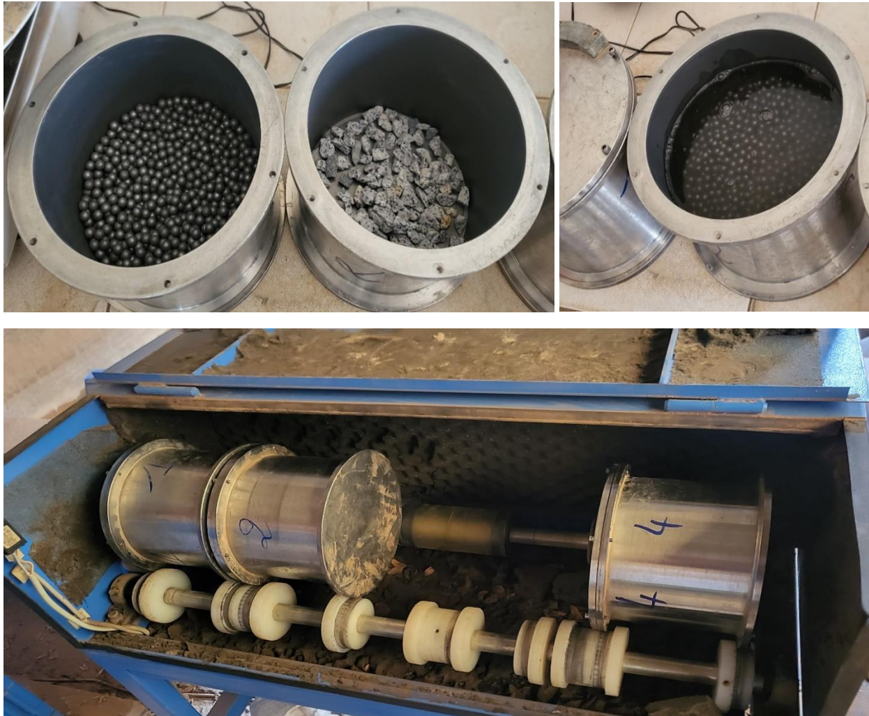
Figure 12: Echantillon, billes inoxydables et appareil Micro-Deval
