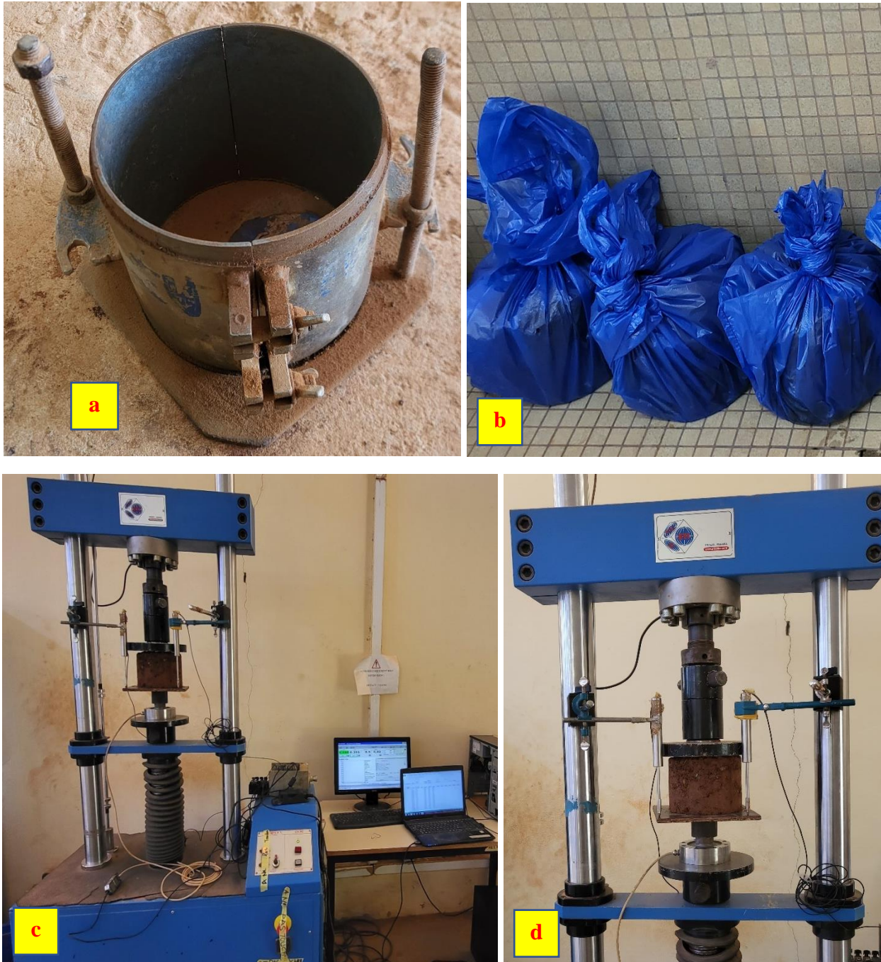
Figure 15: Photo du moule utilisé(a), quelques éprouvettes emballées dans de sachets plastiques (b) et presse universelle (c et d) pour l'essai de compression
