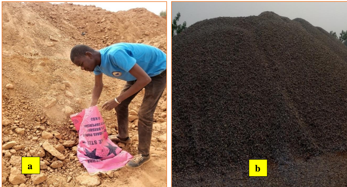
Figure 5:Prélèvement de la latérite (a) et du concassé(b) pour l'étude
