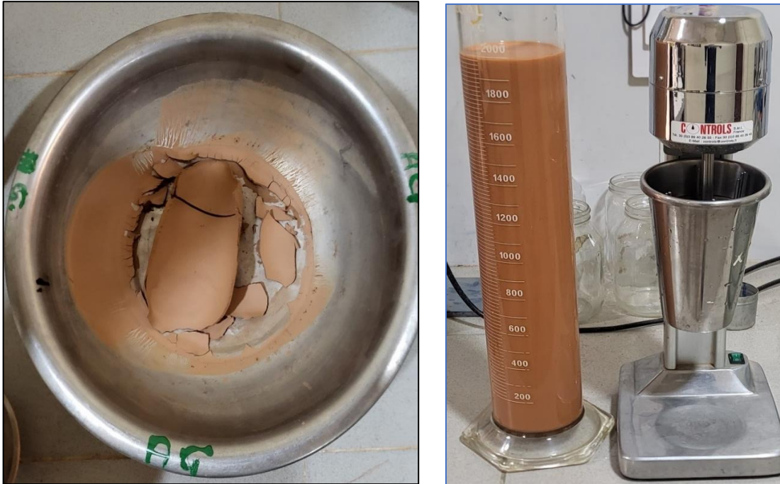
Figure 8: réalisation de l'analyse granulométrique par sédimentométrie
