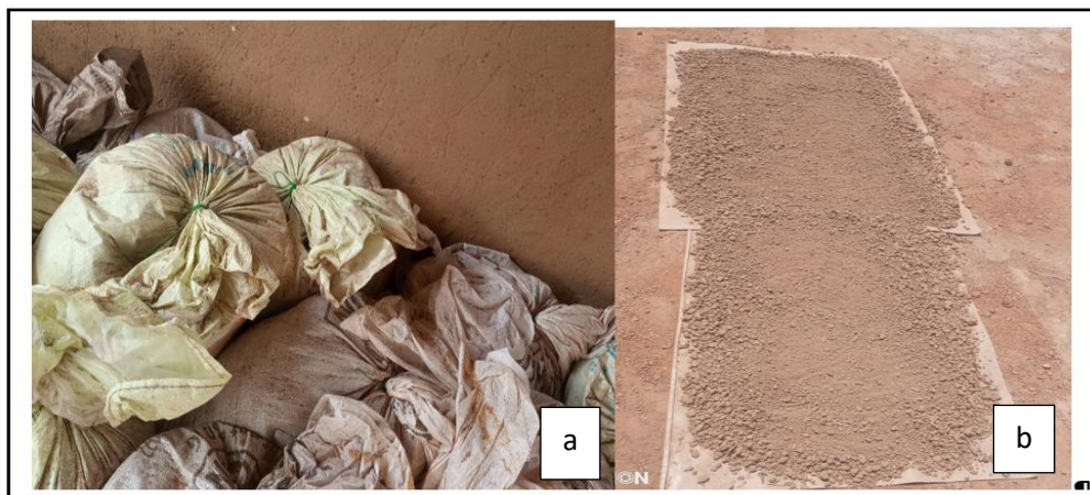
Figure 6 : a) Sacs de prélèvement b) séchage et tamisage au tamis de module 44
