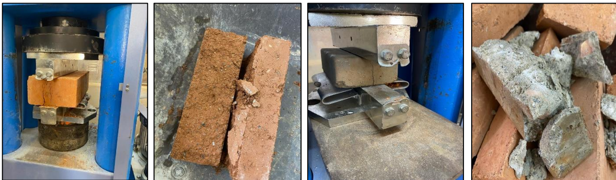
Figure 10 - Essai de fendage sec et humide
