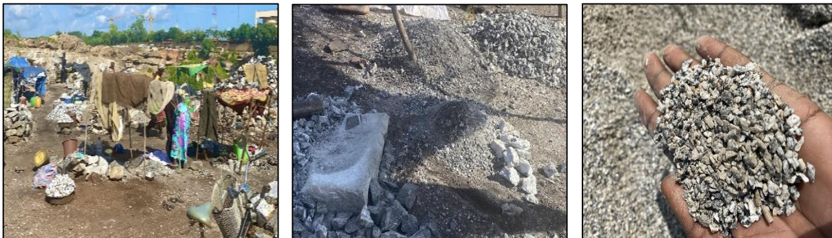
Figure 6 - Provenance et condition de concassage à la carrière de granite de Pissy
