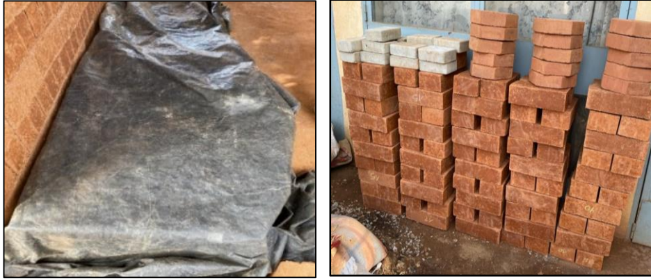
Figure 8- Conduite et condition de cure
