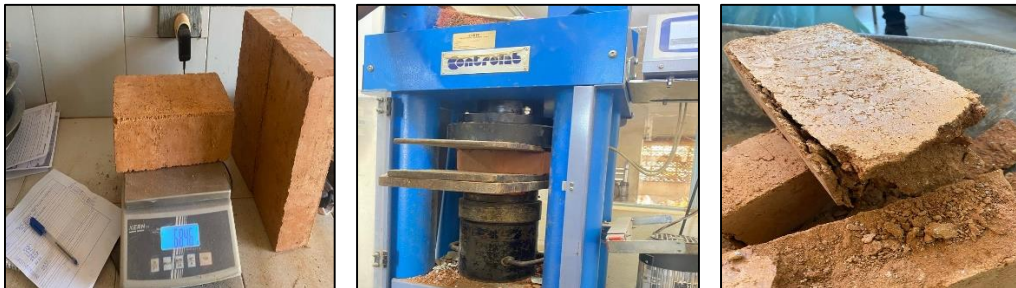
Figure 9 - Essai de compression sèche et humide
