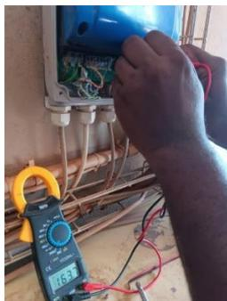
Figure 41: Test de résistance (résistance des bobines de courant de champ) Optiflux 2000
