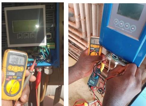
Figure 38 : Test de résistance sur Promag et Optiflux
