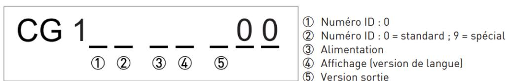
Figure 29: Identification (numéro CG) du module électronique et de la version de sortie
