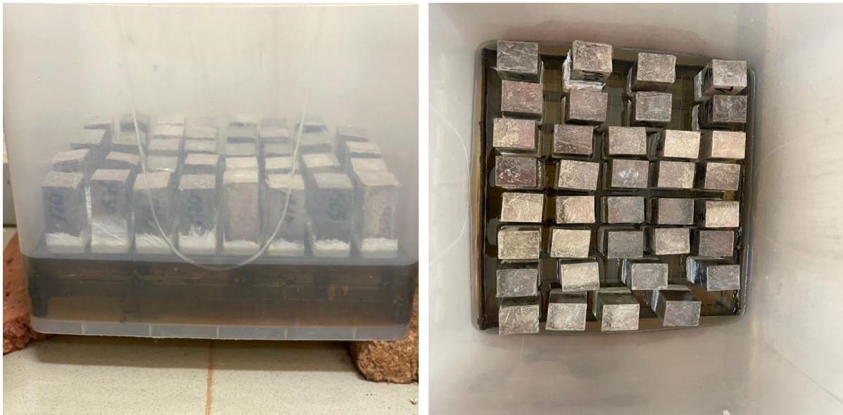
Figure 13 : Essais de diffusion des ions chlorure
