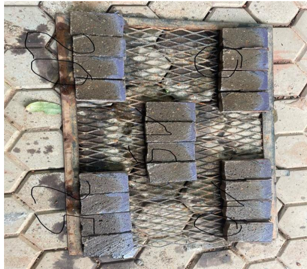
Figure 30 : Profondeur de diffusion des ions chlorure des échantillons (ciment binaire) pendant 60 jours d'immersion
