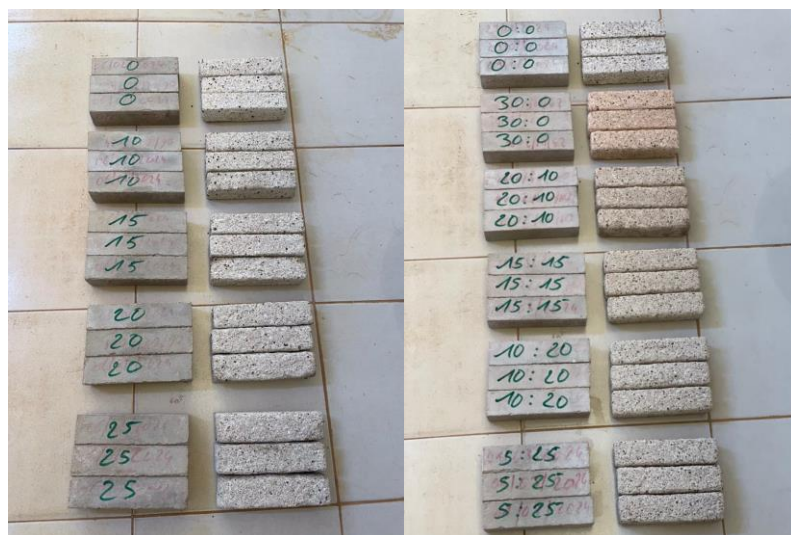
Figure 29 : Aspect physiques des échantillons avant et après attaque acide
